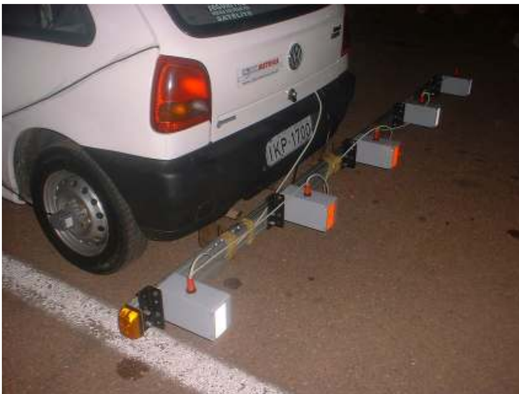
Figura 3 - Veículo com Ciberlaser montado utilizado no levantamento do Univias.
